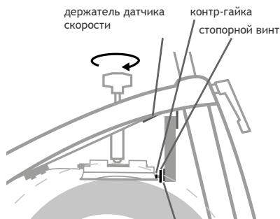
Рис. 28 1 мм между стопорным винтом и датчиком нагрузки
